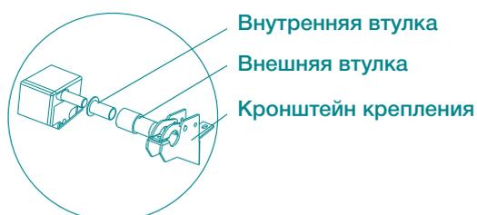
Поднимите массажный блок для ног и подсоедините его к корпусу массажного кресла, совместив ось с кронштейнами крепления, как показано на схеме. После того, как массажный блок для ног будет надежно установлен, опустите с левой и правой стороны специальный замок. Стяните замки винтами для фиксации соединения оси и кронштейна.
